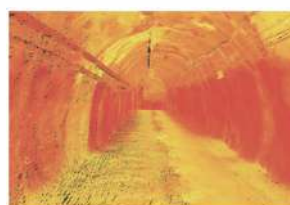
Облака точек тоннелей угольных шахт
